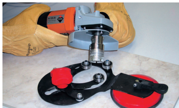
Fot. 7. Wiercenie wykonuje się wprowadzając koronkę w materiał z niewielkim odchyleniem
