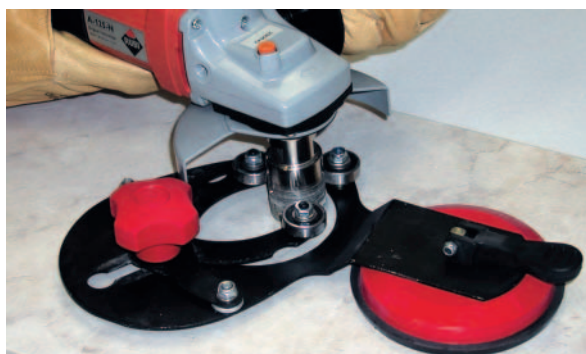
Fot. 6. Koronki wysokoobrotowe pracujące „na sucho” powinny być prowadzone w prowadnicy centrującej ruchem okrężnym
