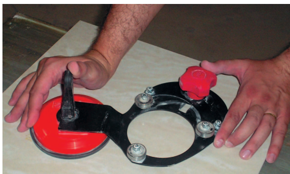
Fot. 5. Prowadnicę centrującą mocuje się do płytki za pomocą przyssawki
