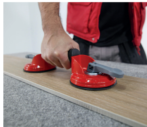
Fot. 1. Przyssawka podwójna do powierzchni chropowatych
