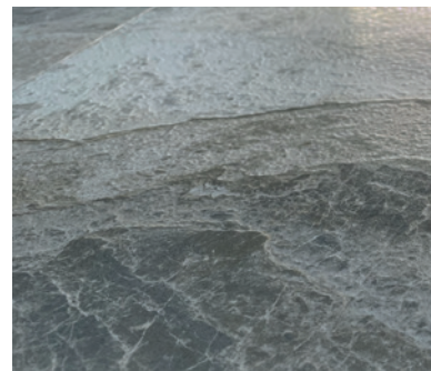
Fot. 3. Przemysłowa produkcja płytki ze strukturą z firmy SMALTICERAM wykonana za pomocą drukarki Gamma DG
