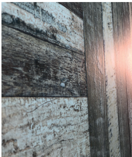
Płytki strukturalne wytworzone z użyciem granilli oraz kleju aplikowanego cyfrowo
