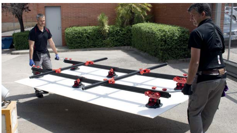
Fot. 3. Przenośnik SLAB TRANS HEAVY DUTY firmy RUBI do transportu płyt wielkoformatowych
