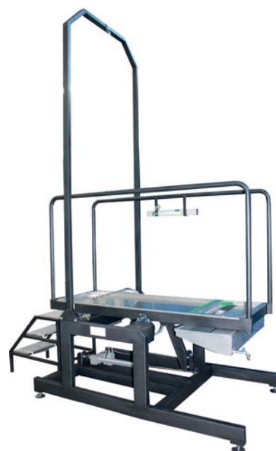
Pochylnia do wykonywania badań odporności na poślizg metodą pochyłającą się ławki dla stopy bosej i obutej
