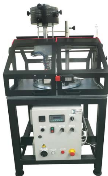
Narzędzie laboratoryjne do wykonywania testu zużycia zgodnie z metodą Mazaud podaną w Załączniku 10 Cahier CSTB 3778_V3 z października 2018 r.
