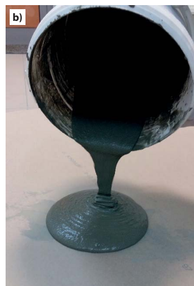
Dobór konsystencji kleju ATLAS GEOFLEX do skrajnie różnego zastosowania: a) klejenie ciężkich płyt w pionie; b) rozpliw zaprawy przygotowanej do klejenia płyt dużego formatu na podłozie
