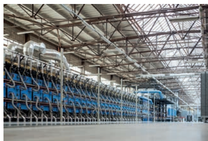
Dwupoziomowy piec rolkowy w zakładzie Rako III pod Rakovnikiem Fot. LASSELSBERGER
